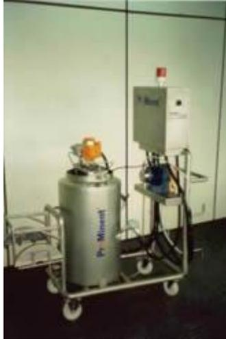
**Figura 8:** Sistema móvel de dosagem de lúpulo
