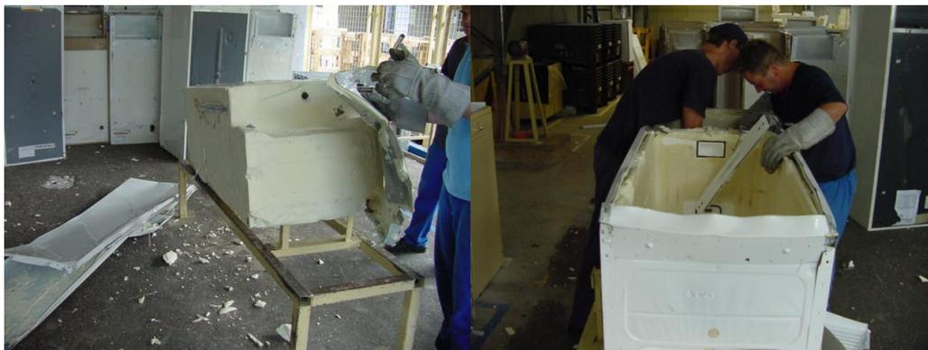
Figura 9 - Desmontagem e seleção das peças dos refrigeradores
