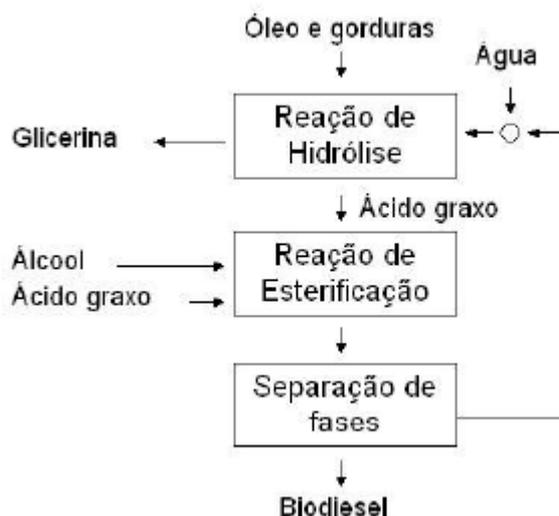
Figura 13 – Processo de hidroesterificação
