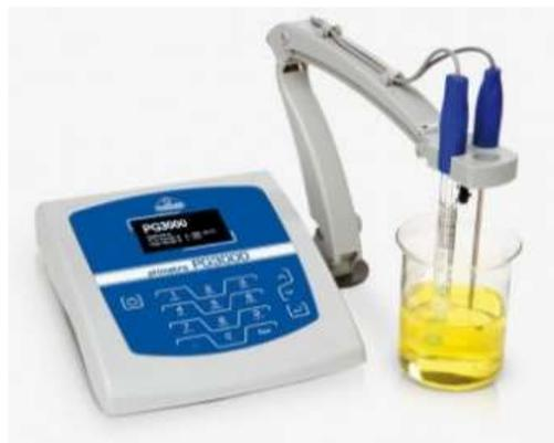
Figura 12 – Medidor pH de bancada
