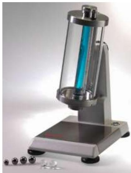
Figura 14 – Viscosímetro de queda de bola
