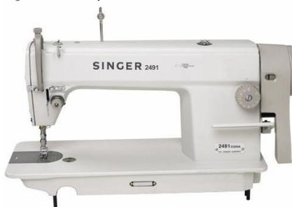
Figura 11 Modelo de máquina tipo reta industrial
