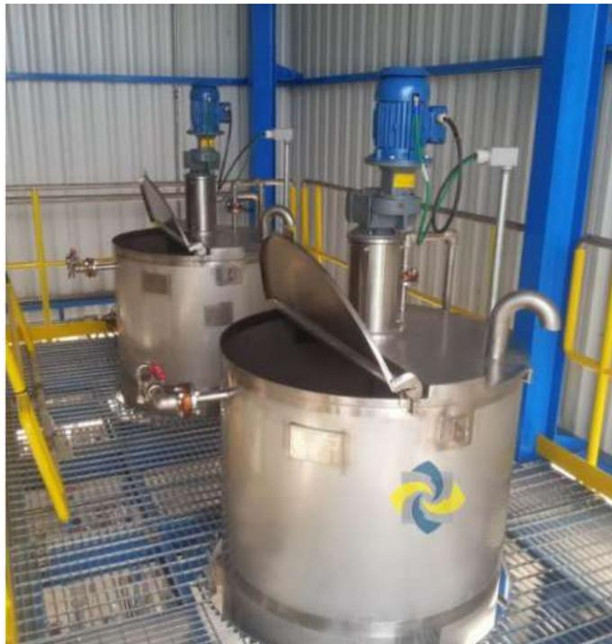
Figura 3 – Tanques com agitadores para homogeneização de líquidos
