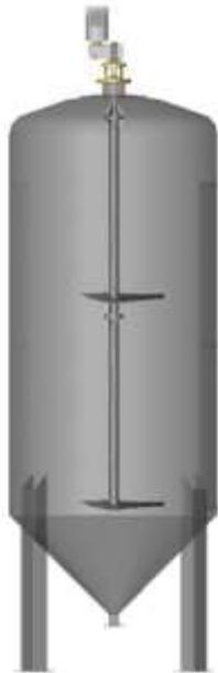
Figura 4 – Tanque com agitador de líquidos
