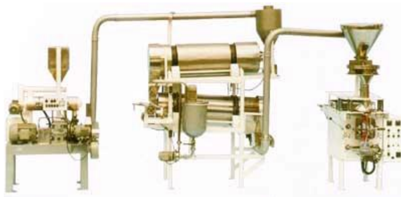
Figura 5. Linha para produção de snacks (capacidade 50kg/hora) Fonte: Inbramaq Tecnologia em Extrusão de Cereais
