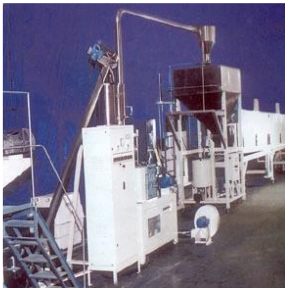
Figura 6. Extrusora para produção de cereais matinais (capacidade 110/140 kg/hora) Fonte: Inbramaq Tecnologia em Extrusão de Cereais
