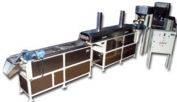
Figura 7. Linha para produção de pellets . Fonte: Inbramaq Tecnologia em Extrusão de Cereais
