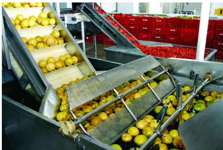
Fig. 4 Equipamento para lavagem dos frutos. Fonte: DOCE MEL.
