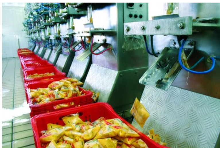
Fig. 7 Equipamento para envase de polpa de fruta. Fonte: DOCE MEL.
